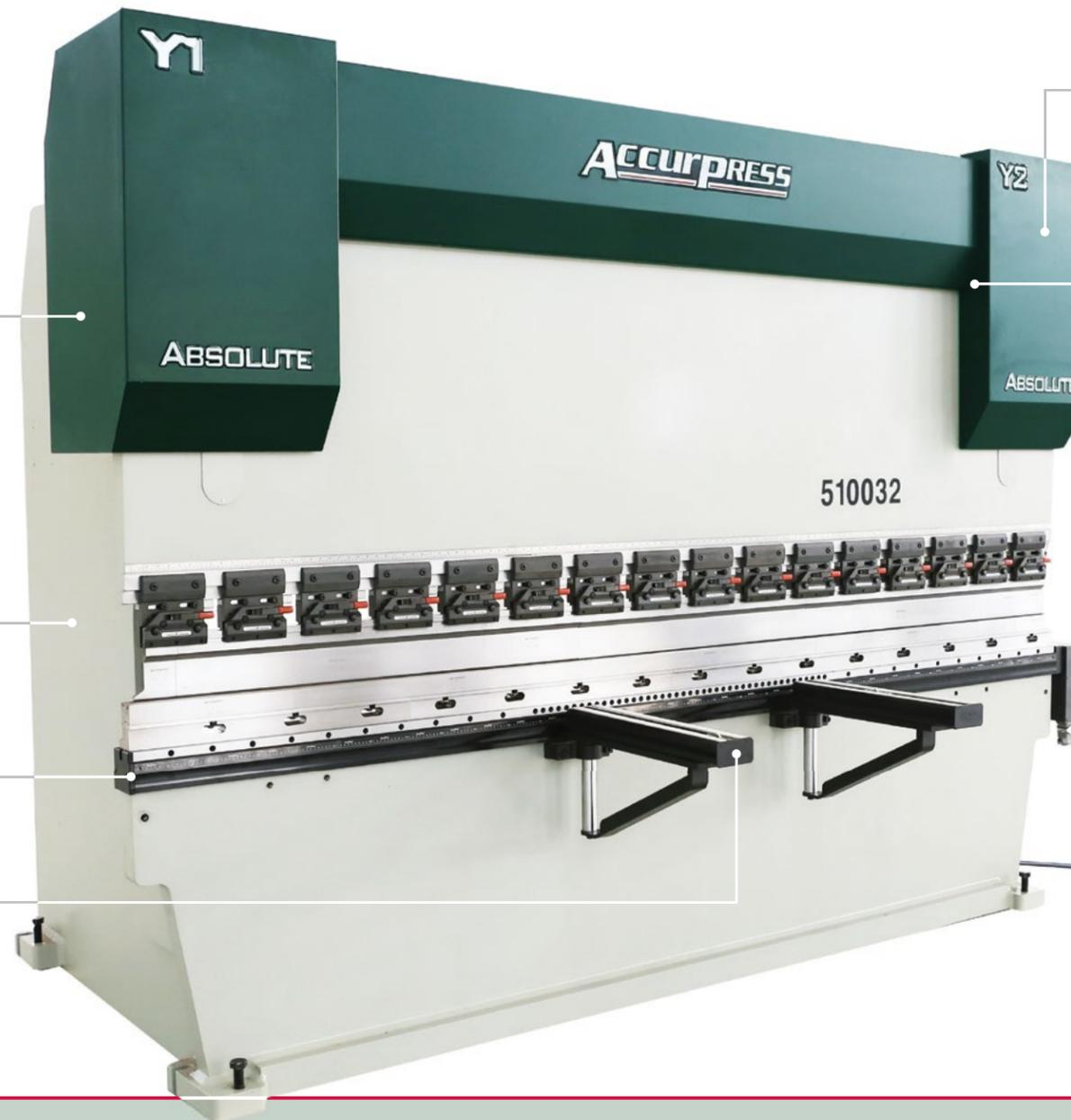
Маломощная гидравлическая система отличается высокой скоростью выдвижения и втягивания силового цилиндра. Точность положения силового цилиндра, а также параллельность силового цилиндра истанины поддерживается независимо от нагрузки и температуры масла.
