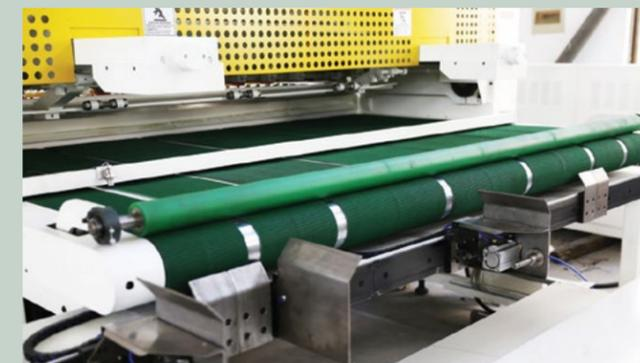
Конвейер Accurshear и система укладки
